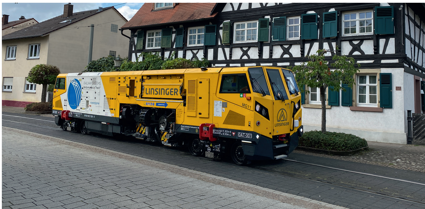
Abb. 2: Linsinger MG11 Schienenfräse der voestalpine Track Solutions Germany GmbH im Einsatz bei der Albtal-Verkehrs-Gesellschaft mbH (AVG)
