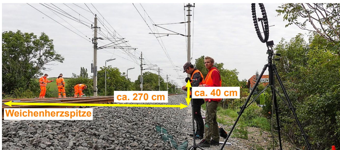
Abb. 8: Messaufbau der Vorbeifahrtsmessung in Pfaffstätten
