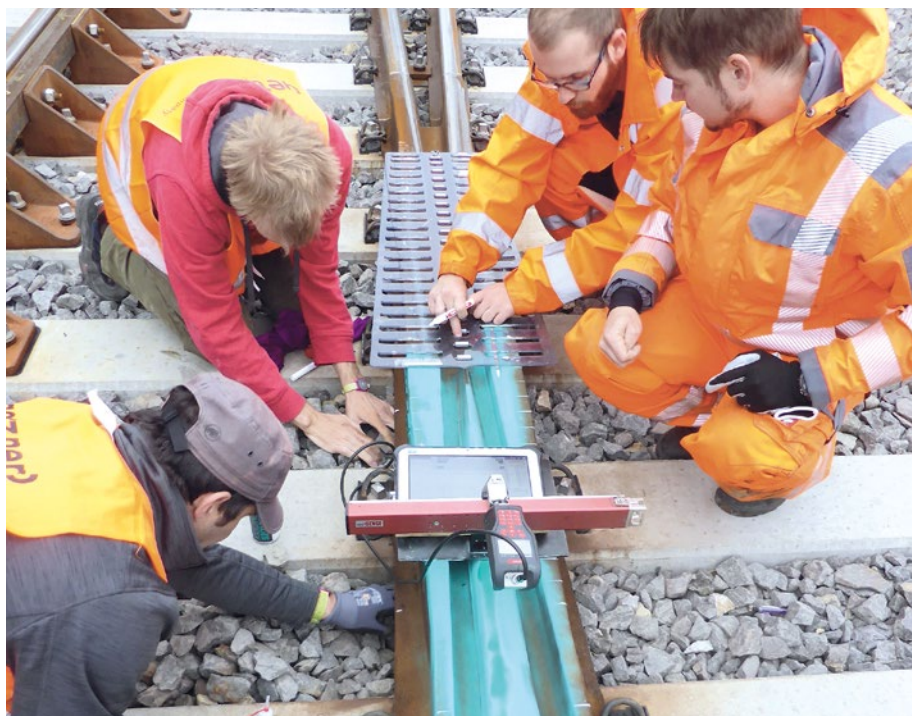
Abb. 7: Vermessung der Weichenherzgeometrie durch die vaRS
