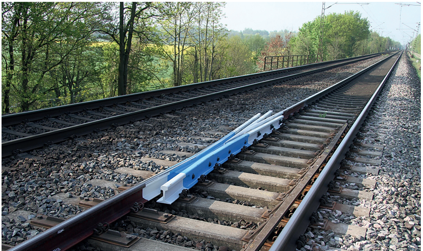
Bild 13: Herzstück der Bauform UHPC in der Versuchsstrecke Haste der DB Netz AG
